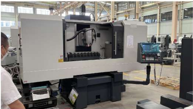
Станок [redacted] с вертикальным шпинделем и нестандартными доработками по требованию заказчика, ЧПУ [redacted]
